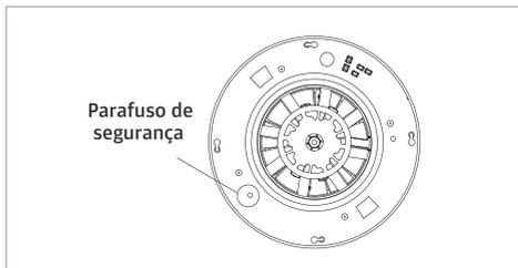
3. Gire o motor desencaixando das torres e puxe o ventilador para fora.
