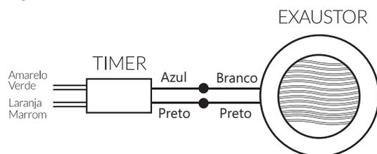
➤ Após unir os fios, passe uma fita isolante em cada união a fim de evitar choque elétrico.
