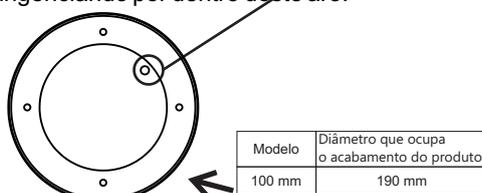
O aro de acabamento do produto, possui 04 furos de fixação. Utilize todos os furos para fixá-lo. Como auxílio para saber onde realizar os furos, primeiro encoste a peça na parede ou teto e centralize o aro no furo realizado na parede. Com um lápis ou similar, marque os furos na parede. Certifique-se que o aparelho está sendo fixado de forma centralizada no furo, para assim não ocorrer nenhum tipo de obstrução em seu funcionamento.
