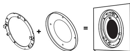
4- Em instalação na parede, execute a instalação do conjunto grade externa na parede do lado externo. A- Primeiro encaixe a capa na moldura. Insira a capa na moldura pela parte superior e depois encaixe a parte de baixo até ouvir um click. Verifique se a capa está bem encaixada. B- Através dos quatro furos nos cantos da grade, realize a instalação na parede.
