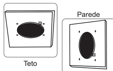
3- Realize a fixação do aro de acabamento e flange de fixação na parede ou teto. Siga as orientações do **gabarito de fixações e distâncias**, que consta nesta página do manual. Quando fixar as duas peças na parede, fixe as duas de uma vez só, alinhando a flange com o aro através dos 04 orifícios.
