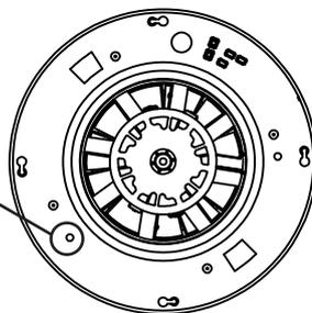
8-Coloque a grade frontal e prenda-a com o parafuso. Observe para que as conexões elétricas estejam alojadas dentro da grade frontal.
