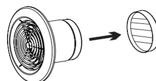
2-Realize no local da instalação um furo no diâmetro de acordo com a **tabela A** para o acoplamento do aparelho e os furos de fixação, seguindo o **gabarito de fixações e distâncias**, que consta nesta página do manual. Atente para a posição de entrada dos fios elétricos.
