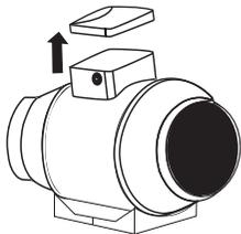
5. Retire a tampa superior do exaustor e retire os parafusos que encontram-se no canto direito.
