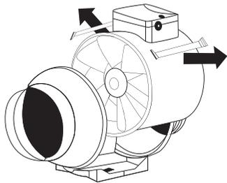
2. Retire o corpo motor do exaustor, retirando as presilhas laterais.
