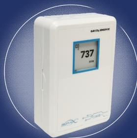
Mede o nível de CO<sub>2</sub> em partes por milhão (0-2000 ppm) usando tecnologia NDIR (sensores infravermelhos não dispersivos), que utiliza a absorção de luz infravermelha para detectar a concentração de CO<sub>2</sub>.
