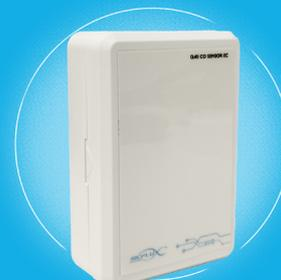
O nível de CO é medido em partes por milhão (0-300 ppm, podendo ser configurável até 500 ppm) por meio de um elemento eletroquímico, que realiza uma reação química gerando uma corrente elétrica proporcional à quantidade de CO no ar.
