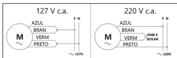
Figura 4.5: Esquema de ligação.
